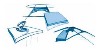
Dovendo spostare diversi pannelli, toglierne solo la quantità minima. Rimuovere alternatamente i pannelli per mantenere il corretto allineamento delle fughe e utilizzare sempre e solo gli appositi attrezzi di sollevamento. In caso di spostamento di pannelli non interi, porre attenzione a riposizionarli nel modo corretto.
