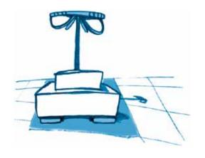
Per lo spostamento di carichi elevati si consiglia l'uso di carrelli a sollevamento con ruote non rigide, interponendo fra queste e il pannello una lastra per poter distribuire il carico, onde evitare di danneggiare la finitura di superfice.
