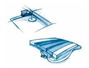
Nell'eventuale spostamento, fare attenzione a non danneggiare le guarnizioni della struttura ed eventuali accessori e connessioni dei pannelli (torrette, pozzetti, griglie, etc.). Sostituire, nel caso di danneggiamento, con materiale integro.
